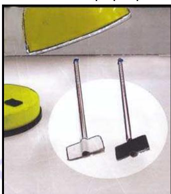
Καλύπτουν το κάτω άκρο ενός θερμομέτρου με ένα κομμάτι λευκής αυτοκόλλητης ταινίας. Καλύπτουν επίσης το κάτω άκρο ενός άλλου θερμομέτρου με ένα κομμάτι μαύρης αυτοκόλλητης ταινίας το οποίο να έχει ίδιες διαστάσεις με το κομμάτι της λευκής. Τοποθετούν τα δύο θερμόμετρα κοντά το ένα στο άλλο, κάτω από ένα πορτατίφ με σβηστό το λαμπτήρα του. Γράφουν τις τιμές της θερμοκρασίας των δύο θερμομέτρων σε δύο διαφορετικά χαρτάκια, χωρίς να γράψουν πάλι ποια τιμή αντιστοιχεί σε ποιο θερμόμετρο.
