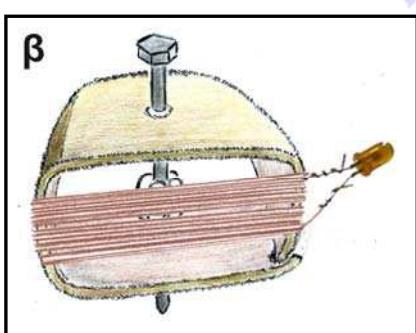
Παρατήρησε στην εικόνα β ένα αυτοσχέδιο δυναμό ή, όπως γενικά λέγεται, μια ηλεκτρική γεννήτρια. Φαίνεται ένα πλαίσιο από χαρτόνι, μια βίδα και μαγνήτες. Ποιο μέρος της ηλεκτρικής γεννήτριας νομίζεις ότι λείπει για να ολοκληρωθεί η κατασκευή της; Πού; Σχεδίασε.
