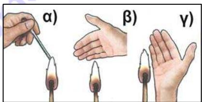
'Ενα από τα πιο απλά πειράματα για τη μελέτη και επιβεβαίωση των τρόπων ψύξης ή θέρμανσης φαίνεται στο σχήμα. α) Η θερμότητα μεταδίδεται με αγωγή μέσα από τη μεταλλική ράβδο, β) η θερμότητα μεταφέρεται πάνω από τη φλόγα με ανοδικό ρεύμα του αέρα και γ) η θερμότητα διαδίδεται με ακτινοβολία, όπως διαπιστώνεται στην περίπτωση που δεν υπάρχει αγωγή ή ανοδικό ρεύμα, όμως το χέρι θερμαίνεται.
