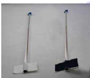
Κάλυψε τα άκρα του ενός θερμομέτρου με λευκή αυτοκόλλητη ταινία και το άκρο του άλλου θερμομέτρου με μαύρη αυτοκόλλητη ταινία. Βάλε και τα δύο θερμόμετρα σε ένα σημείο ώστε να φωτίζονται από τον ήλιο. Μετά από λίγα λεπτά μέτρησε και τις δύο θερμοκρασίες.
