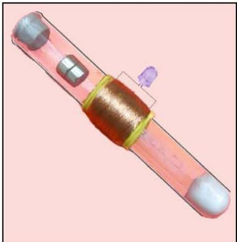
Άλλοι μαθητές τοποθέτησαν σε έναν γυάλινο σωλήνα, με πώμα στο ανοιχτό άκρο του και λίγο βαμβάκι στο κλειστό άκρο του, όποια εξαρτήματα χρειάζονταν για να κατασκευάσουν οι ίδιοι ένα ηλεκτρικό φανάρι, όπως φαίνεται στη διπλανή εικόνα.
