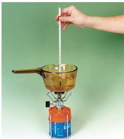
Η δασκάλα ή ο δάσκαλός σου έχει βάλει λίγο νερό σε ένα διάφανο πυρίμαχο δοχείο. Με έναν μαρκαδόρο έχει σημειώσει τη στάθμη του νερού στο δοχείο. Χρησιμοποιώντας ένα καμινέτο θερμαίνει το νερό στο δοχείο και μετρά τη θερμοκρασία του νερού κάθε δύο λεπτά. Αφού σβήσει το καμινέτο και περιμένει λίγο, για να κρυώσει το νερό, σημειώνει ξανά τη στάθμη του νερού στο δοχείο. Τι παρατηρείς;
